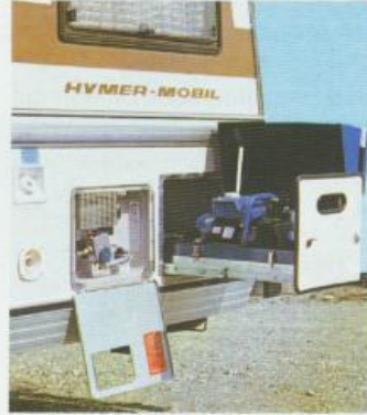
Generator und Heißwasserboiler
